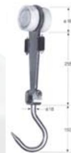
Carrello birotaia sagomato a laser sp. 10 mm inox, con sagoma tonda antiurto, ruote da 90 mm in nylon 6 cuscinetti 15-42-13 rullini di scorrimento in nylon da 19 x 45 mm con cavalletto a snodo in piatto 30 x 8 mm inox con gancio bovino da 18 mm inox
