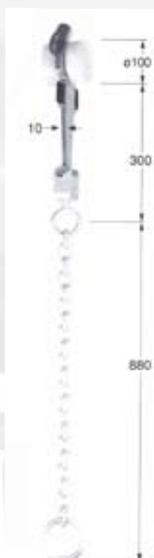
Carrello birotaia per laccetto bovino sagomato al laser sp. 12 mm zincato, attacco paranco, ruote da 100 mm in nylon 6, rullini di scorrimento da 19 x 45 mm in nylon con catena per laccetto da 10 mm ed anello
