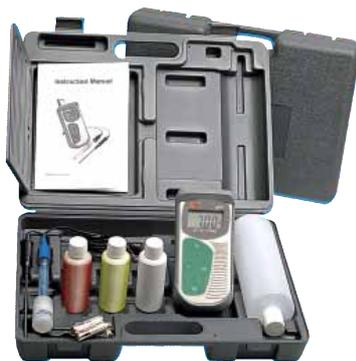
Phmetro portatile con microprocessore e compensazione temperatura con sonda, tamponi certificati con valigetta trasporto
